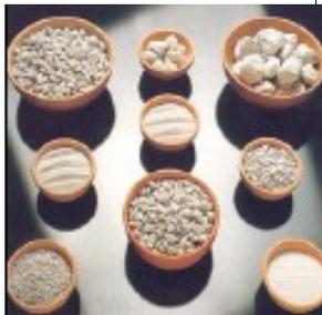
Utilizzazioni prevalenti: in granuli come inerte nei calcestruzzi alleggeriti termo-fonoisolanti per massetti o in blocchi, nell'impasto degli intonaci per l'isolamento termico e la resistenza al fuoco.
